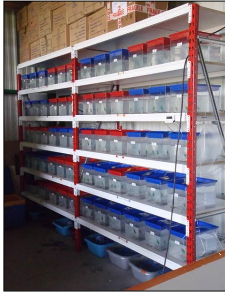
Figure 19 : Organisation des tests de mortalité en laboratoire (FISH-PASS)
