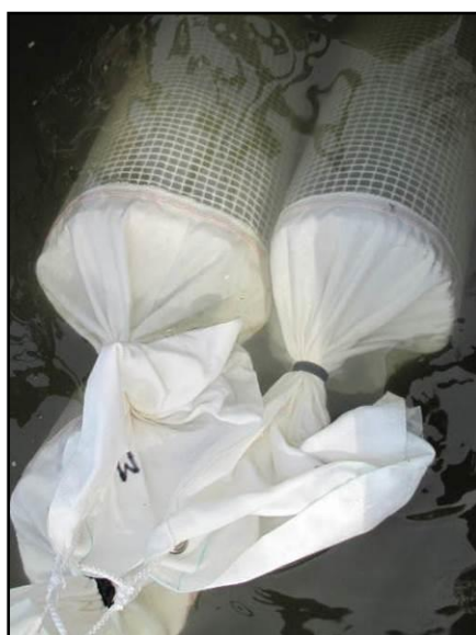
Figure 45 : Préparation des enceintes avant immersion pour les tests in situ (FISH-PASS)
